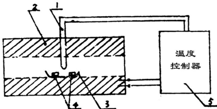
1. 热电偶； 2. 高温炉(温度剃度炉)； 3. 瓷舟； 4. 样品； 5.(可控硅)温度控制器
